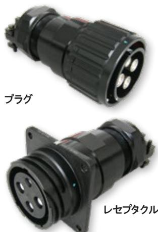
ITS 901シリーズは、AWG#4～262 MCM (35～120 mm<sup>2</sup>)の電源ケーブルに対応しており、電流容量は最大450Aまで、使用電圧はAC800～1000Vです。負荷側ピンコンタクトの先端に、感電防止処置が施されています。床下や車間ジャンパー線として車両の振動に耐えることのできる嵌合技術となっております。
