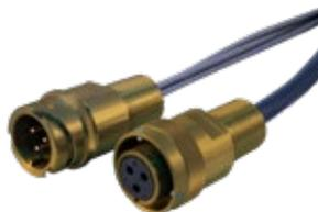
ITSシリーズは、軍用車両向けのリバースバヨネット嵌合コネクタで、最新のDLAやVG規格要求に基づく表面処理クラスに対応しております。すず亜鉛めっきのクラスIIは、カドミウムフリーのRoHS適合表面処理で、高い導電性とシールド性能を持ち、腐食耐性があります。そして、従来のカドミウムや亜鉛ニッケル、ニッケル PTFEめっきと同等程度の性能を持っております。
