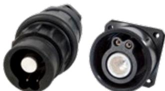
スティングーコネクタは、電気が流れている状態でコネクタを外そうとした時、電源を遮断できる短絡コンタクトを内蔵した単極給電用コネクタです。プッシュプル嵌合方式で、プラグ側コネクタの外側はゴムで覆われ完全に絶縁されておりますので、安全性は確保されております。
