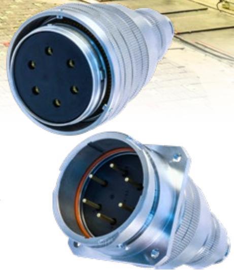
**G**lenair Super NG (Nuclear Grade)シリーズは、最も厳しLOCA条件である長期間浸水、60年間の熱サイクル模擬試験、長期間放射線暴露などに耐性があるコネクタです。クラス1E原子力環境要求の放射線、高温環境、地震や高圧などへの耐性として、切削加工されたステンレススチール製シェルに、特殊ポリマー製インサートを使用。60年間システム寿命の性能を発揮できるよう設計されており、
