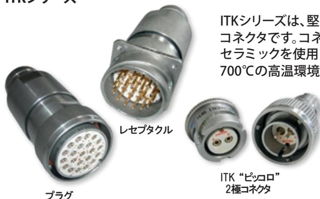
ITKシリーズは、堅牢設計のリバースバヨネット嵌合方式の高温耐性を持つコネクタです。コネクタ本体にステンレススチール、インサートに特殊高温セラミックを使用しております。
