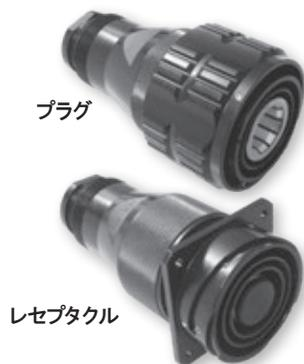
ITS 500シリーズは、AWG#3/0～444MCM (95～240 mm<sup>2</sup>)の電源ケーブルに対応しており、電流容量は最大750Aまで、使用電圧は3000Vccです。負荷側ピンコンタクトの先端に、感電防止処置が施されています。欧州軍用規格VG96929の電源コネクタをベースにしております。
