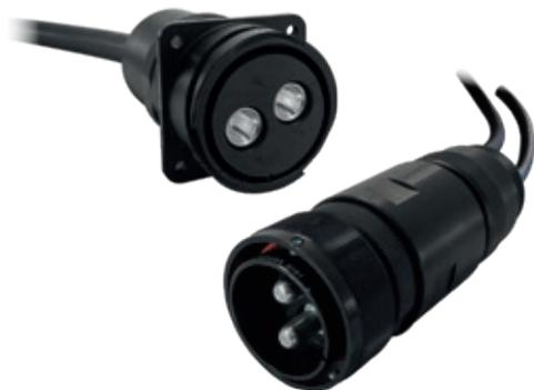
「ケーブル1本-コンタクト2本」：このコネクタは、シールド保護されたコネクタで1本の70mm<sup>2</sup>ケーブルをレセプタクルコネクタの中で、35mm<sup>2</sup>の2本のコンタクトに分け、プラグコネクタを介し、2本のケーブルにシールドされた電源電流を流すことができます。
