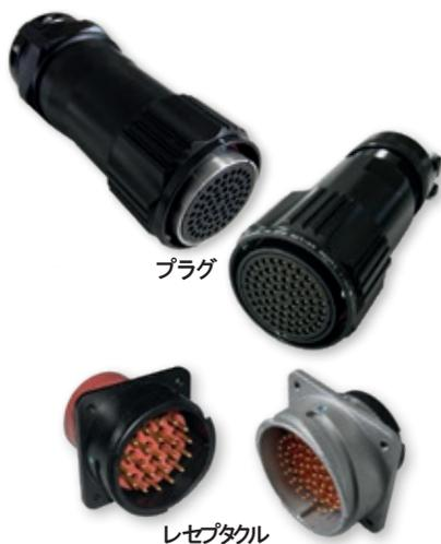
ITHシリーズは、米軍規格MIL-DTL-5015をベースにしたコネクタに、改良バヨネット嵌合方式を組み入れております。プラスチックインサートと圧着コンタクト採用により、より優れた絶縁効果が実現でき、そして作業性向上に役立ちます。3点のポジティブロック機構を持つ嵌合構造により、着脱を簡単にしながらも振動や衝撃に対して信頼性の高い耐久性を持ち、誤って外れてしまうことを防止します。
