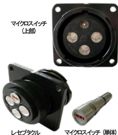
マイクロスイッチ内蔵コネクタは、簡易着脱バヨネット嵌合方式で、着脱状態の監視により安全性を高めた堅牢設計の鉄道用コネクタです。AWG#4/0サイズのコンタクト3本とセンサーの役割をするコンタクト1本で構成され、嵌合した時にのみ、機能する設計となっております。
