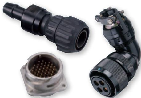
FR-ITSシリーズは、難燃/発煙/毒性要求の鉄道車両材料燃焼性試験に合格した難燃性ゴムを使用したITSコネクタです。防水要求有無に関わらず、幅広くご採用いただいております。
