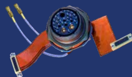
FPCとリジット・フレキシブル基板複合組立 38999 - Micro-D - RFケーブル
