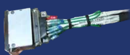
熱収縮スリーブ施工一例
