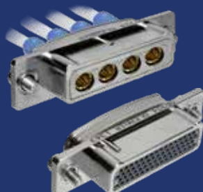
精密機械加工された79シリーズ Micro-Crimp™ 小型Dサブコネクタ コネクタシェルに覆われた基板コンタクト・ EMI特性としてのグランドフィンガー・誤嵌合防止のシェル極性
