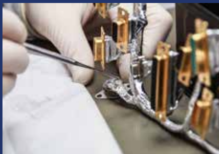
GSSが準備した治具での 形状・配置・機能保証する 試作ハーネス
