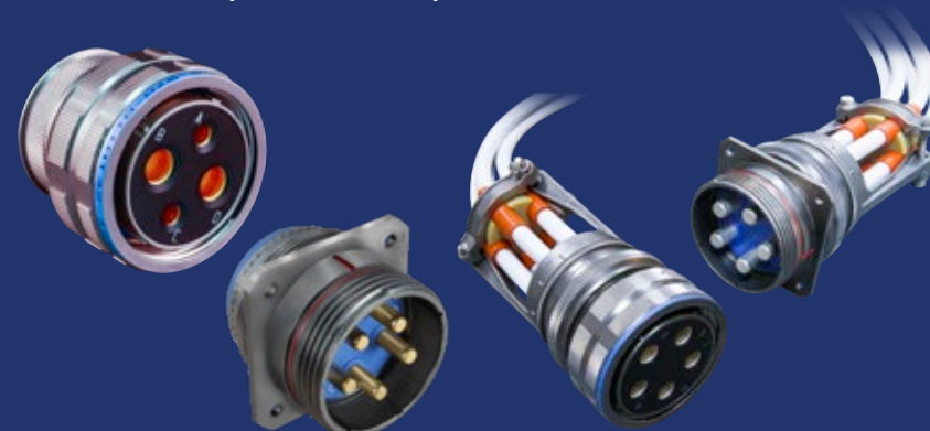
高密度・高度特性を持つ PowerTrip™ コネクタ 5015由来電源インサート配列 + 38999由来三条ネジ嵌合 + 28840由来堅牢ネジ より高い定格電流・First-Make Last-Mate技術・ EMIフィルタ・ガラスハーメチック
