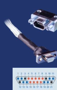
10GbE伝送高速 Micro-D <21ピン配線例> 青:高速信号 黒:ドレイン線 橙:低速信号・電源
